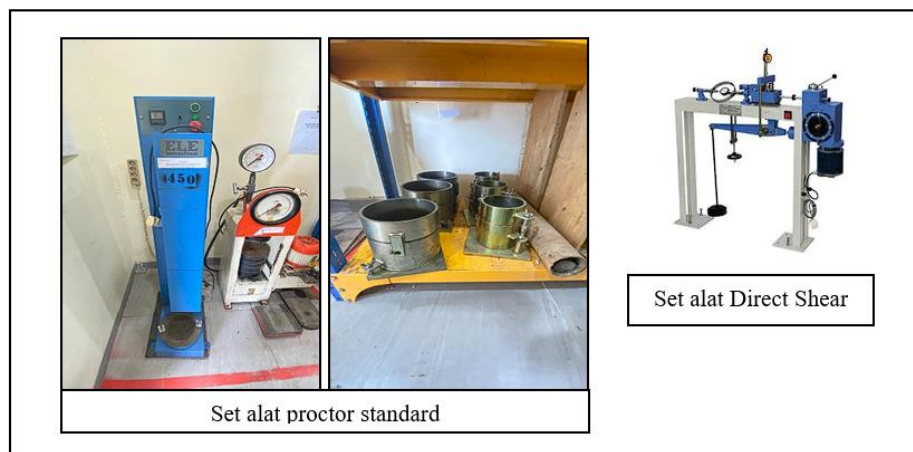
Gambar 4. Set Alat Uji Proctor dan Direct Shear
