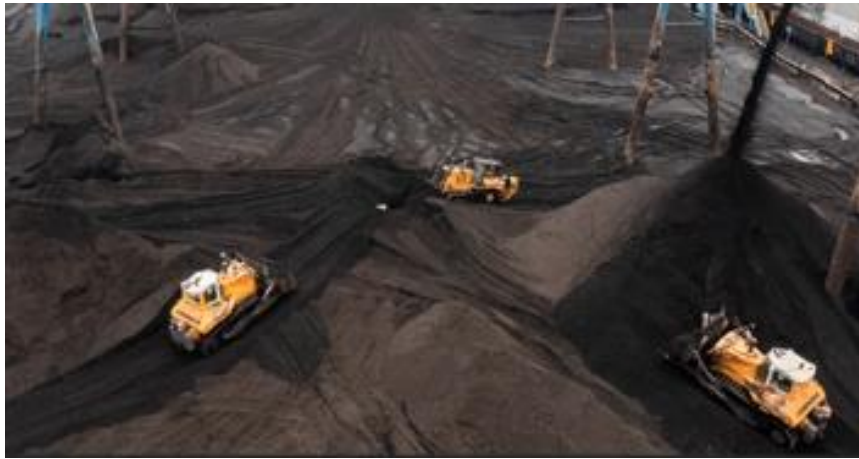
Gambar 4. Pemadatan Timbunan Batubara secara Berlapis
